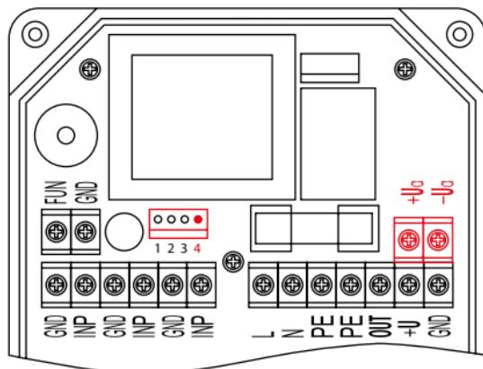
Подключение системы GIDROLOCK GSM к блоку управления GIDROLOCK ENERGY:
